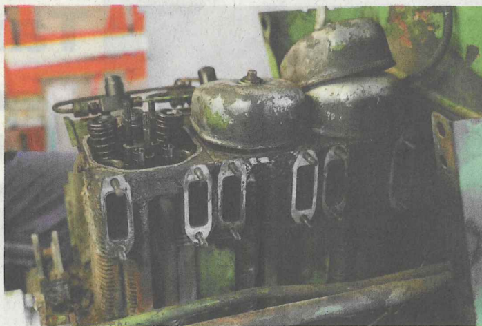
Russ, Staub und Öl verklebten die Einzelteile.
